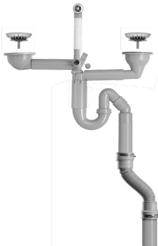
Vattenlås för dubbellåda med korgventil och stretchslang Art. nr 8962080 RSK nr 8124251 Vattenlås med teleskopsarmar och stretchslang, flexibel i längd från 200-520mm, anpassat för montage i höj/sänkbara underskåp. Dimension 50mm.
