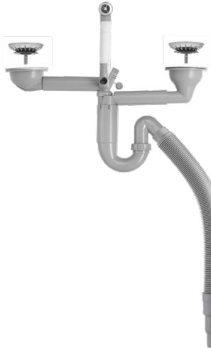
Vattenlås för dubbellåda med korgventil och flexislang Art. nr 8964080 RSK nr 8124253 Med bälgrörmuff 40/50.
