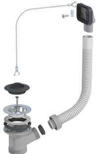
Bottenventil med bräddavlopp och försänkt silbricka. Art. nr 13963 RSK nr. 8086611 För diskbänk, utslagsback mm. Rektangulärt bräddavlopp, kapbar bräddavloppsslang. Levereras med propp och kedja. Dimension G40 mm. För hål Ø 50 - 55 mm.
