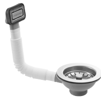
Korgventil med bräddavloppssats Art. nr 890182 RSK nr 8055461 Komplett korgventil med rektangulärt bräddavlopp för hål 48x25mm. Passar Contura Shine och Sharp diskådor.
