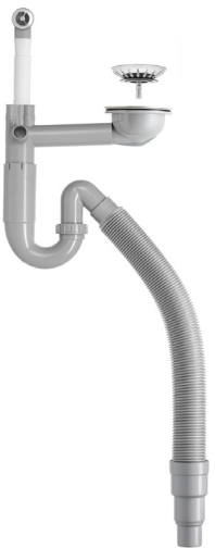
Vattenlås för enkellåda med korgventil och flexislang Art. nr 8963080 RSK nr 8124252 Vattenlås med teleskopsarm och flexibel utloppsslang kpl. med bälgrörmuff 40/50.
