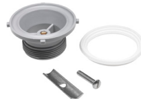
Ventil 37 Art. nr 8862080 RSK nr 8084766 Kan monteras i låda med hål Ø 48-55mm, komplett med fäste, skruv och packning, höjd 37mm. Passar Contura Pro Rotlås. Dimension G40.
