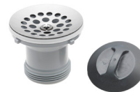
Ventil 55 Art. nr 8863080 RSK nr 8084774 Kan monteras i låda med hål Ø 48-55mm, komplett med sil, propp och packning, höjd 55mm. Passar Contura Pro Rotlås. Dimension G40.
