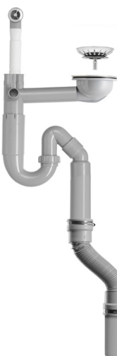
Vattenlås för enkellåda med korgventil och stretchslang Art. nr 8961080 RSK nr 8124250 Vattenlås med teleskopsarm och stretchslang, flexibel i längd från 200-520mm, anpassat för montage i höj/sänkbara underskåp. Dimension 50mm.
