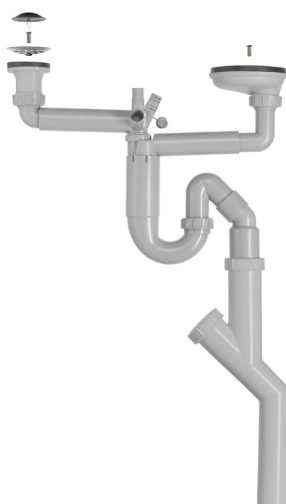
Vattenlås för dubbellåda med stucken sil Art. nr 8996080 RSK nr 8084751 Vattenlås anpassat för stor/liten stansad sil i lådorna, max Ø 105mm samt Ø 55mm. Dimension G40x50mm.
