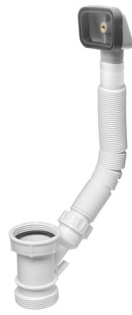
Bräddavloppsanslutning CU 44 Art. nr 8859081 RSK nr 8055456 Komplett med slang, packning och rektangulärt bräddavlopp. Dimension G40.
